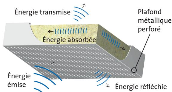
L'absorption acoustique d'un plafond suspendu se définit par sa propension à réduire l'énergie sonore en l'absorbant totalement ou partiellement. Ce pouvoir d'absorption est évalué par le coefficient  $\alpha_w$  permettant la comparaison des performances acoustiques allant de 0 (pas d'absorption) à 1 (absorption totale).
